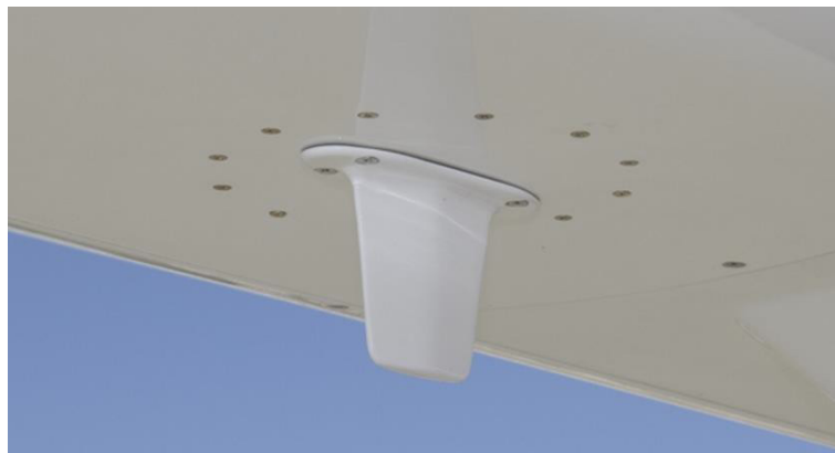
図 2 航空機の胴体に取り付けられた代表的なブレードアンテナ
