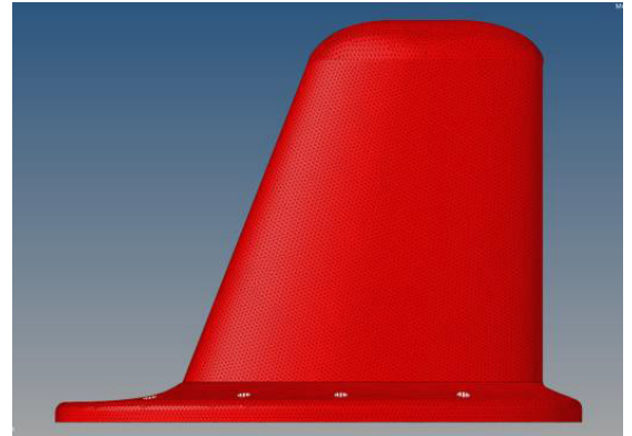
図7 - アンテナの構造有限要素モデル
